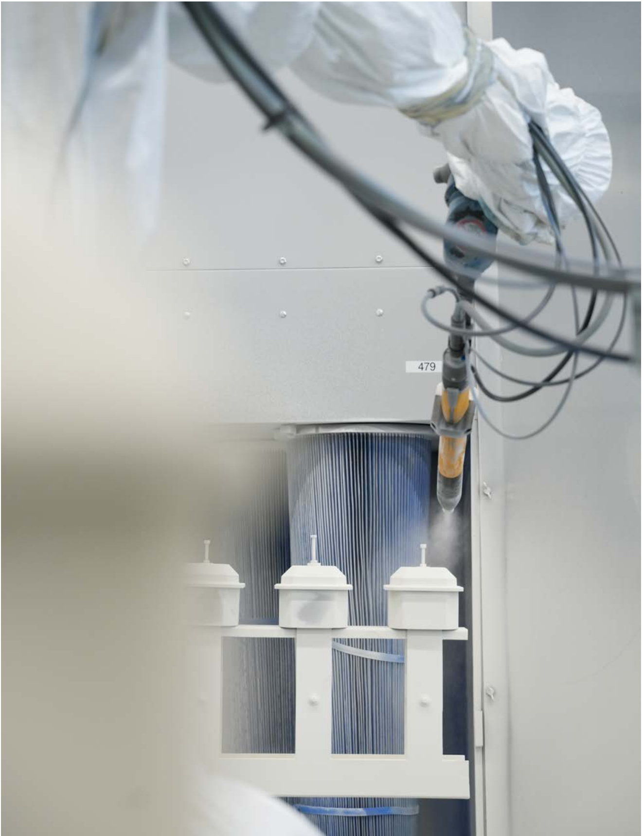
Pulverbeschichten auf der Durchlaufanlage inkl. Vorbeschichtungsroboter
